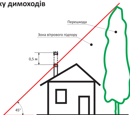
Нарощування димоходу при наявності перешкод біля будівлі
